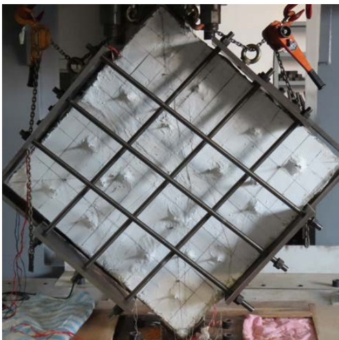
圖 13 試體 UV-D20-W 各面破壞圖
