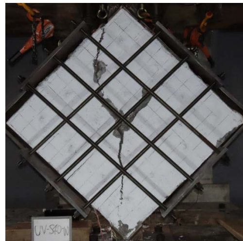
圖 10 試體 UV-S40-W 各面破壞圖
