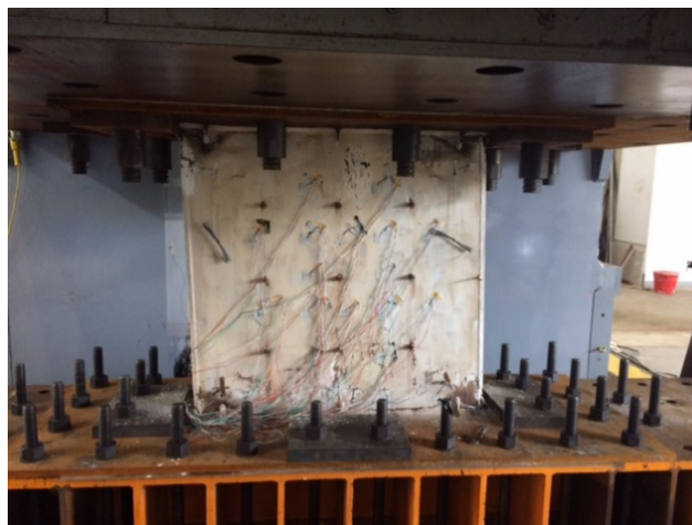
圖 1 試體安裝配置情形
