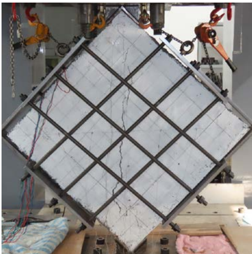
圖 12 試體 US-D20-W 各面破壞圖
