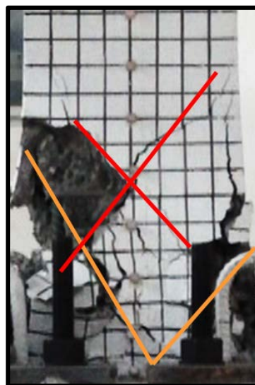
圖 13 D250_0.1 試體剪力裂縫分布圖
