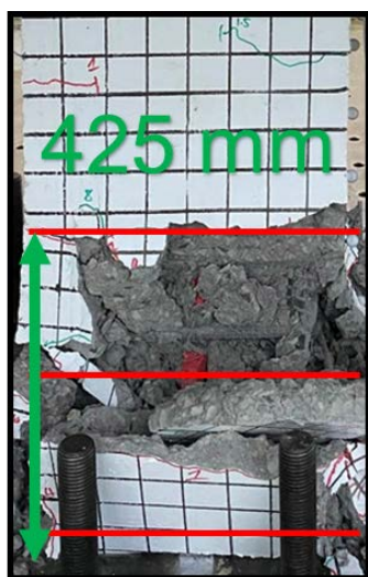
圖 10 S_0.1 試體撓曲裂縫分布圖
