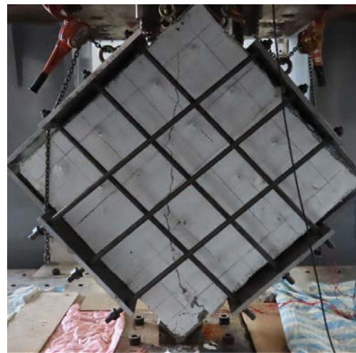
圖 13 試體 UV-D20-W 各面破壞圖
