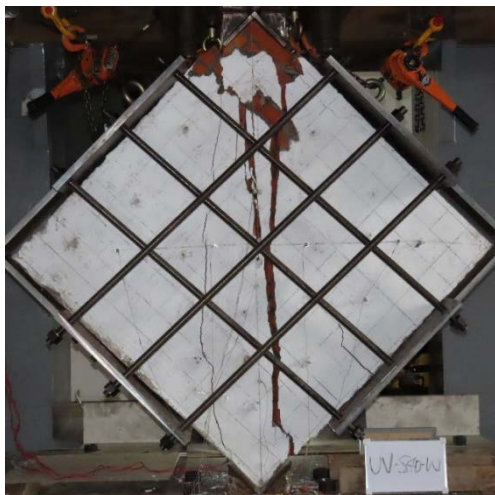
圖 10 試體 UV-S40-W 各面破壞圖
