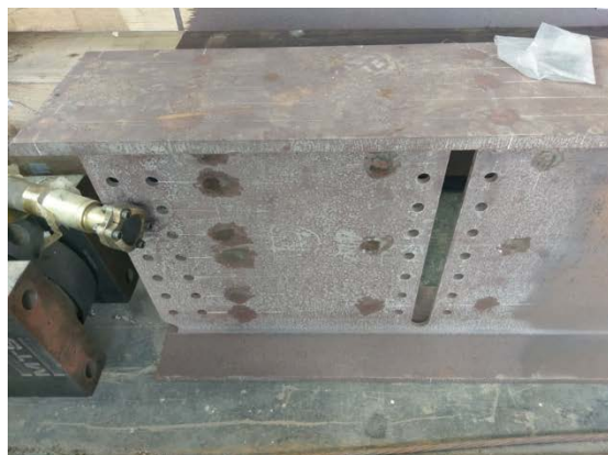
圖 2 梁腹開孔後增設摩阻型螺栓接合
