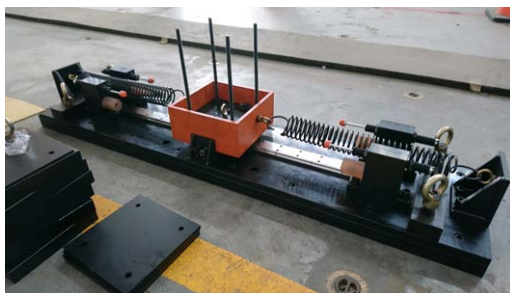
(c) 調諧質量阻尼器(TMD)
